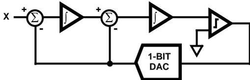
FIGURE 9. HI7190 2ND ORDER SIGMA DELTA MODULATOR
